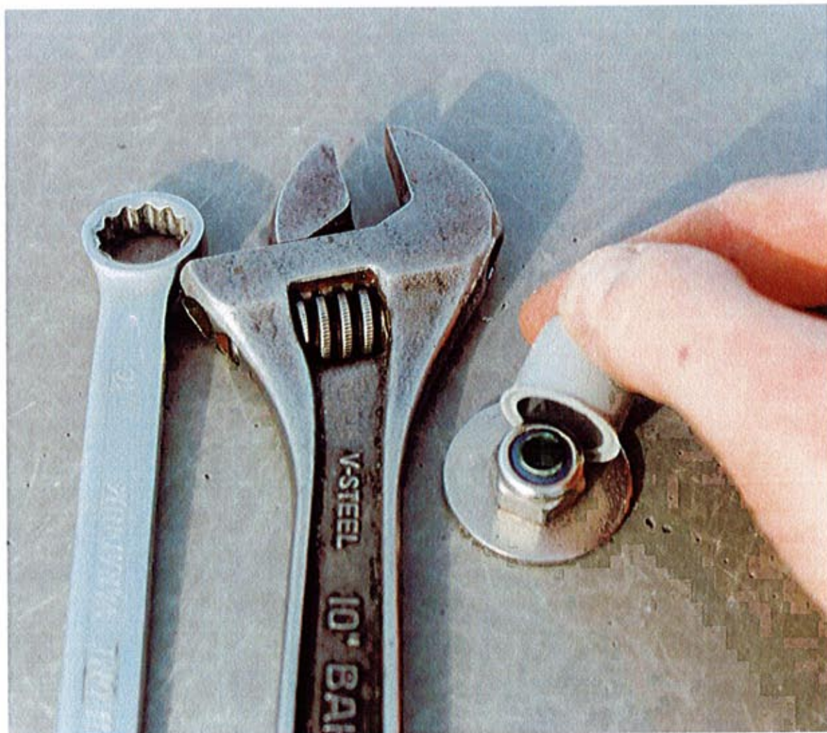
Foto 1 Låsanordningen i låst läge tillsammans med lämpliga verktyg som kan öppna låsningen.
